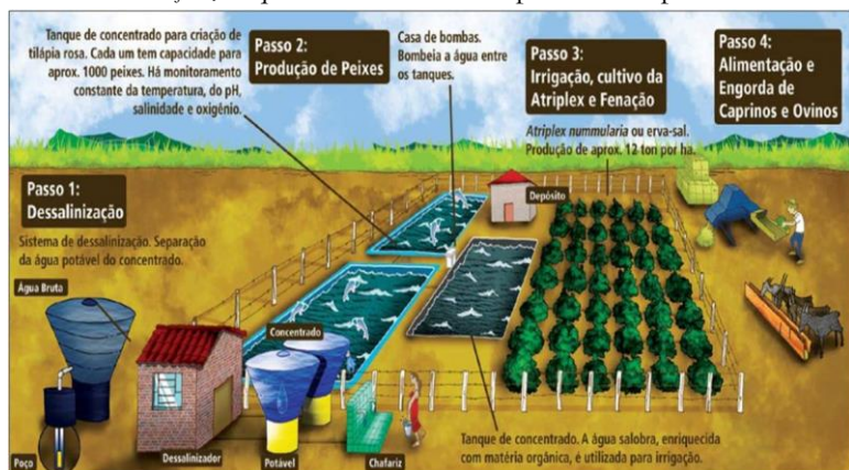
Figura 2 – Desenho esquemático do sistema integrado de dessalinização, esquema desenvolvido pela Embrapa Semiárido
